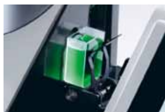
Mesure de liquides en transmission
