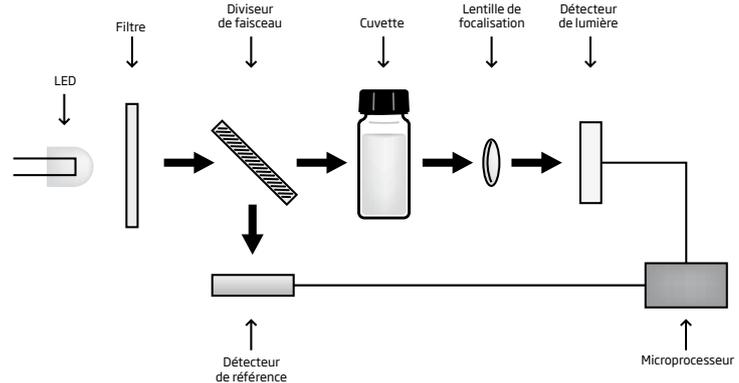
Le nouveau système optique compense toute variation pouvant être occasionnée par des fluctuations de l'alimentation électrique ou des changements de la température ambiante. La source lumineuse LED garantit une émission identique et stable entre le test à blanc et la mesure. De nouveaux filtres optiques assurent haute précision de longueurs d'ondes, excellente transmission d'intensité et stabilité de mesure.
