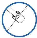
**Pourquoi ?** - L'électrolyte de référence assure le pont électrolytique, son écoulement vers l'extérieur de l'électrode est de règle. En cas de niveaux d'électrolyte trop bas, les mesures sont erronées (ne concerne pas les électrodes à remplissage gel et solide).
