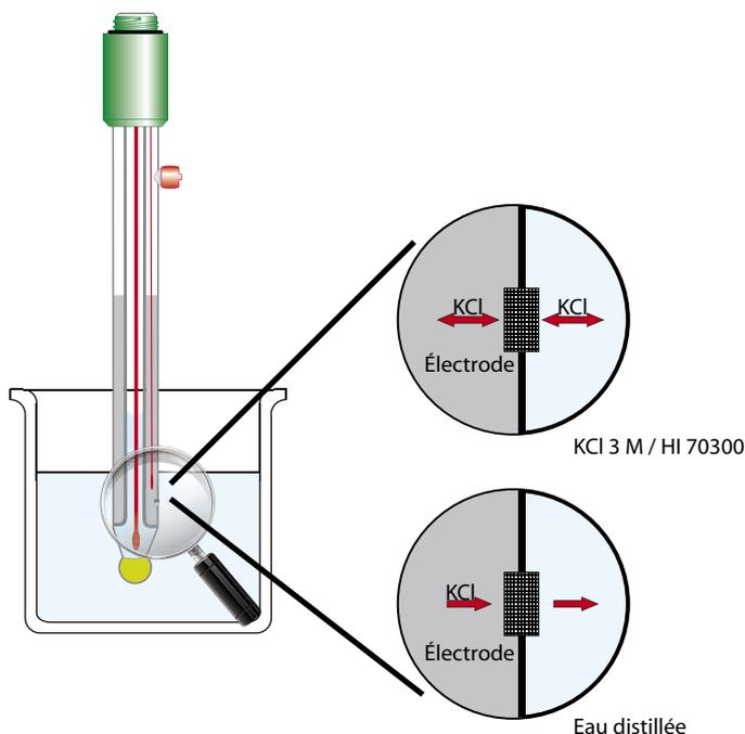
À l'appui de nos retours d'expérience, nous constatons régulièrement que certains utilisateurs confondent nettoyage et conservation des électrodes et emploient de l'eau distillée pour conserver leur électrode. Ce traitement est très nocif pour les électrodes à remplissage, «fatal» et irréversible pour les électrodes à électrolyte gel.
