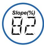
**Pourquoi ?** - Au fil du temps, la membrane en verre sensible s'altère occasionnant des mesures erronées. Une détérioration liée à l'usage peut aussi en être une cause.
