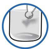
**Pourquoi ?** - En frottant le verre pH spécifique, la surface de contact se charge d'électricité statique provoquant des interférences sur la mesure.
